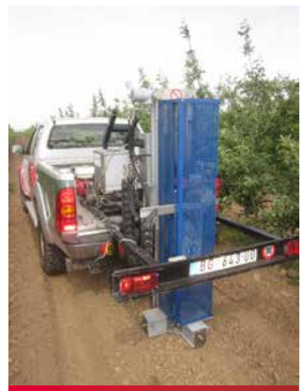
Slika 3 i 4. Vozilo sa automatskom opremom za uzorkovanje zemljišta
