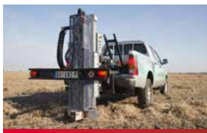
Slika 3 i 4. Vozilo sa automatskom opremom za uzorkovanje zemljišta
