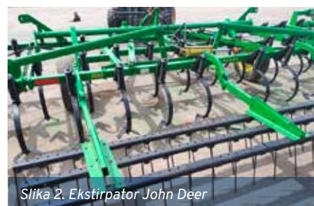
Slika 2. Ekstirpator John Deere (sajt za prodaju polovne mehanizacije)
